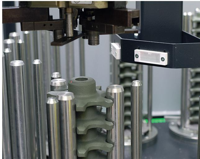
3 Abweichungen der Rohteilmaße beeinflussen die Abnahmeposition nicht, da über einen Näherungsschalter stets die korrekte Höhe des obersten Teils für den Roboter ermittelt wird
